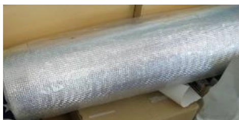
使用したアルミ断熱シート
